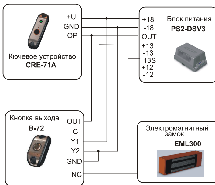
Рис.1 Схема подключения КУ
