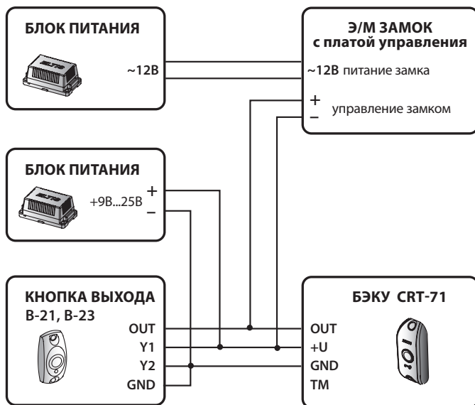
Рис.3 Схема подключения CRT-71 к замку с платой управления и кнопке выхода В-21(В-23)
